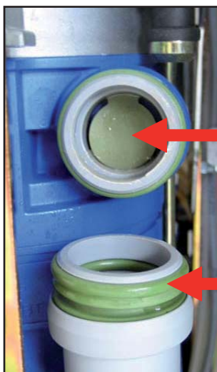
Ausgang Separierstufe Outlet Separator drain
