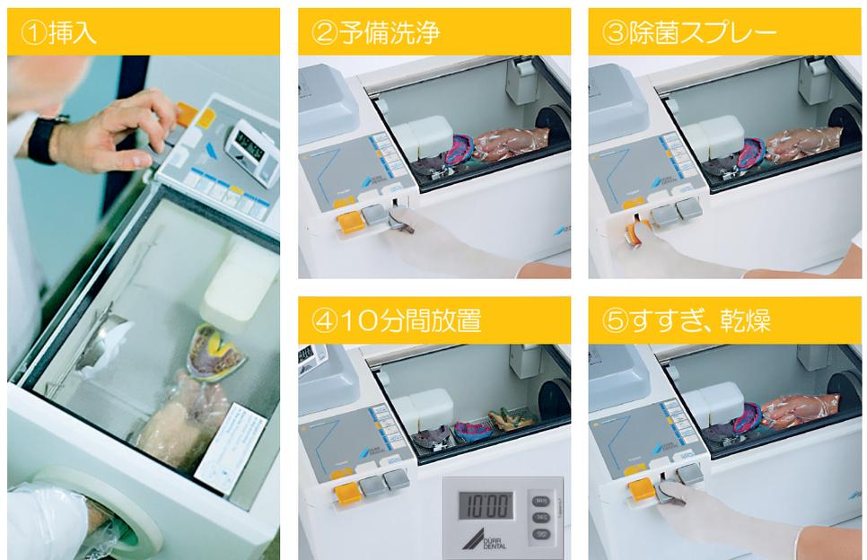
ハイゴジェット設置にはエア、水道と排水の接続が必要です。「MD520インプレッション」の印象体／技工物の除菌液を使用します。
