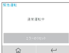
緊急運転は、機器の構成部品の1つにエラーが発生しても、機器または機器グループの動作を継続させることができます。
