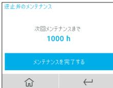
運転開始(1000h)から次回メンテナンスまでカウントダウンされます。0になるとメッセージを表示し、「メンテナンスを完了する」をタップすることでカウントダウンをリセットします。
