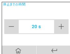
バキュームホースをハンガーに戻した後、停止するまでの時間を設定します。10～60秒の間で設定することができます。グループシステムの場合は、必ずメインの機器で設定してください。
