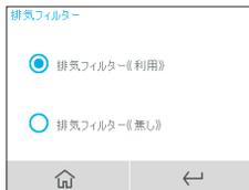
バクテリアフィルターの接続に応じて、「排気フィルター《利用》」、「排気フィルター《無し》」を選択することができます。「排気フィルター《利用》」を選択すると、「排気フィルターのメンテナンス」のメッセージが表示されるようになります。
