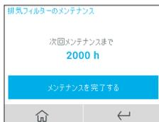
運転開始(2000h)から次回メンテナンスまでカウントダウンされます。0になるとメッセージを表示し、「メンテナンスを完了する」をタップすることでカウントダウンをリセットします。
