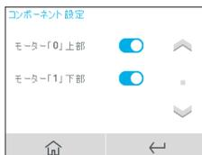
ブロアーの「モーター「0」上部」、「モーター「1」下部」の有効/無効を設定できます。これにより、一方または両方を停止してメンテナンスすることができます。正常時は両方のブロアーが稼働しています。
