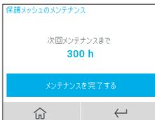
運転開始(300h)から次回メンテナンスまでカウントダウンされます。0になるとメッセージを表示し、「メンテナンスを完了する」をタップすることでカウントダウンをリセットします。
