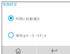
「使用時に自動的適応」、「常時全モーター《オン》」を選択することができます。「使用時に自動的適応」は吸引力に応じて自動的に制御します。「常時全モーター《オン》」では、消費電力の増加や摩耗が早くなる可能性があります。
