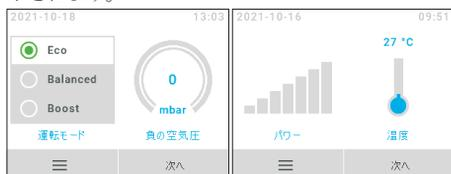
ホーム画面で設定された「運転モード」と現在の「負の空気圧」を表示します。「次へ」をタップすると現在の吸引圧力と装置内部も温度が表示されます。「次へ」でホームの画面二つを切り替えます。
