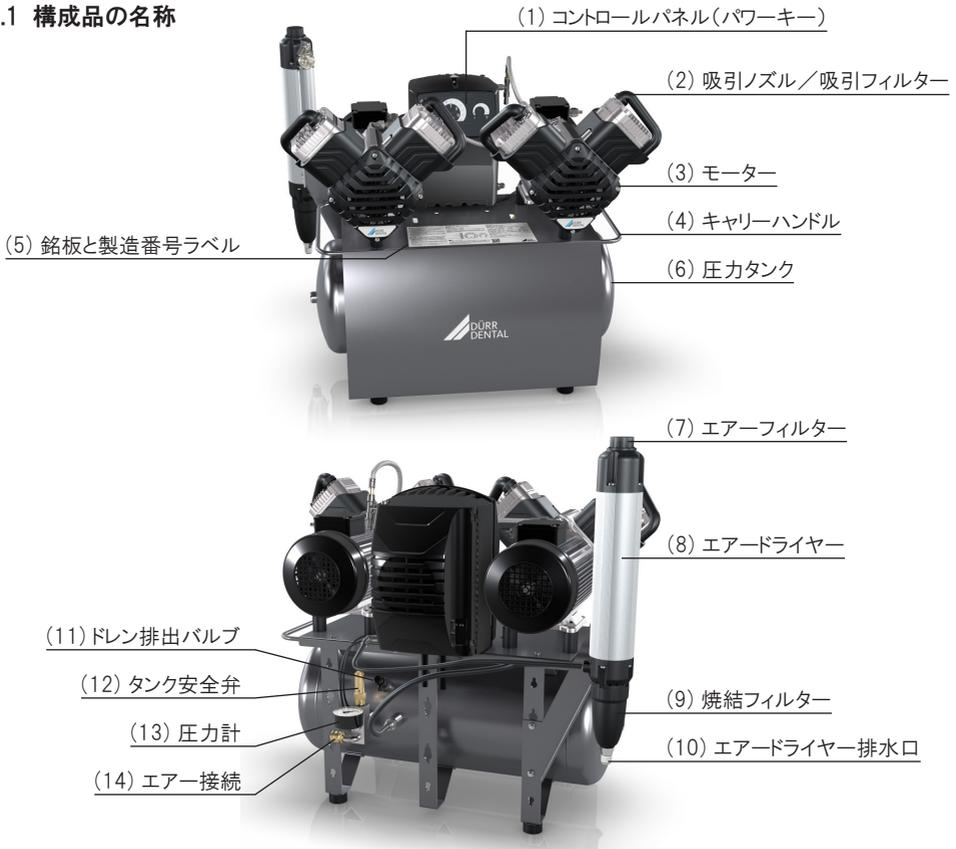
コンプレッサーは室内の空気を吸引し、その空気をオイルフリー状態で圧縮します。圧縮されたエアは冷却器やエアドライヤーを通過し、湿気が除去されます。オイルフリーかつ清潔で乾燥したエアは、タンクに貯えられます。
